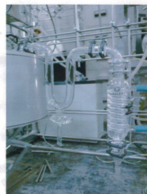
ボトムフラスコのオーバーフロー 部分です。冷却器より排水します。
