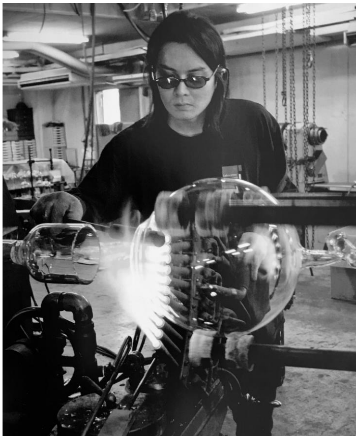
が ら す せん ばん か こう 硝子旋盤による加工
