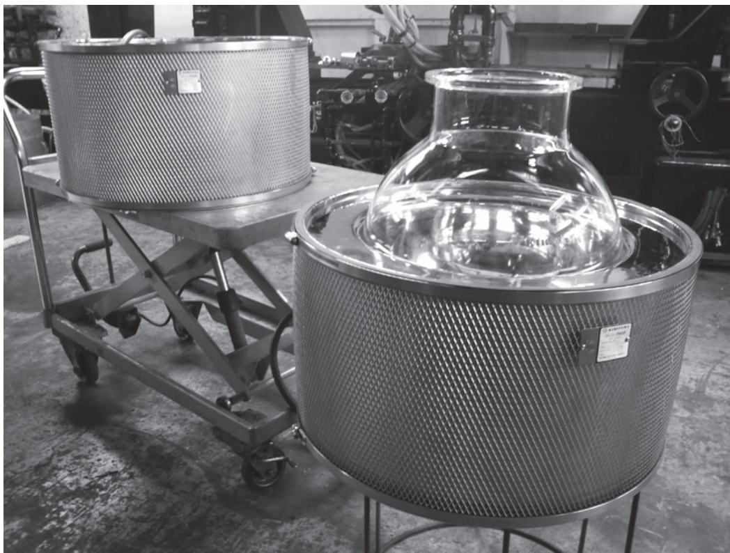
20ℓ丸型セパラブルフラスコ合わせ製作モノヒートです。
