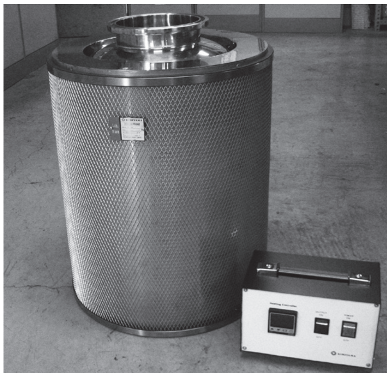
20ℓ SUS製円筒容器合せ製作モノヒートです。
