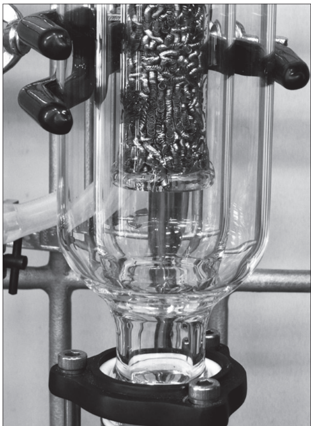
蒸留塔下部。外側は真空ジャケット付保温管によりフラッシングを防ぎます。
