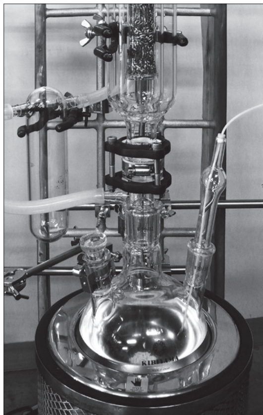
ボトムフラスコ部。安全マンテルヒーターモーターとの組み合わせ参考例です。
