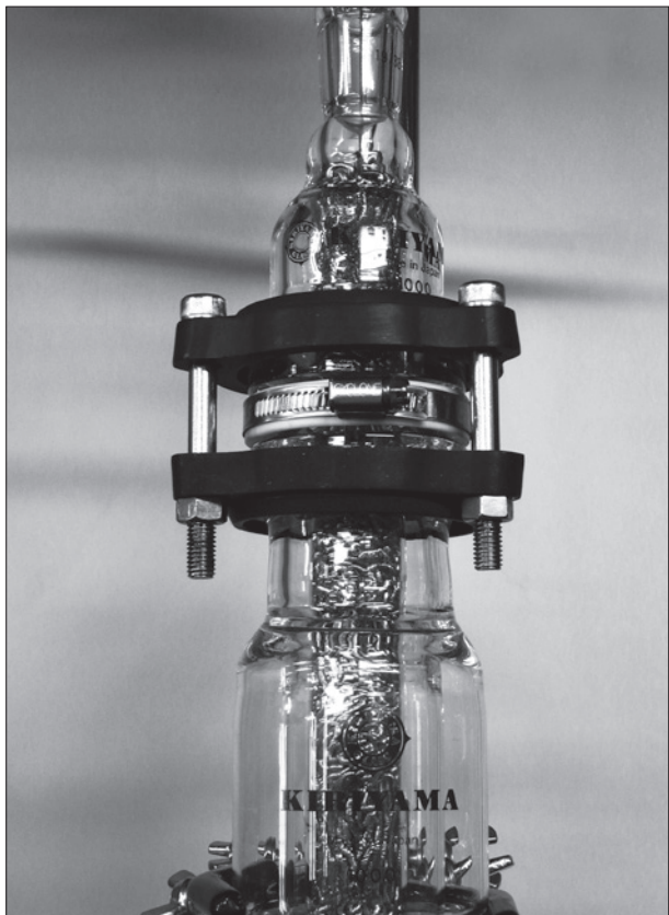
蒸留塔上部です。ボルトを外し内部の充填管を交換できます。内部の洗浄も容易です。
