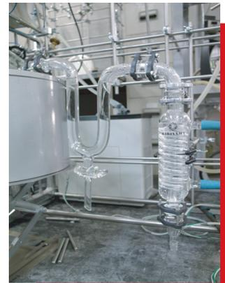
ボトムフラスコのオーバーフロー部分です。冷却器より排水します。
