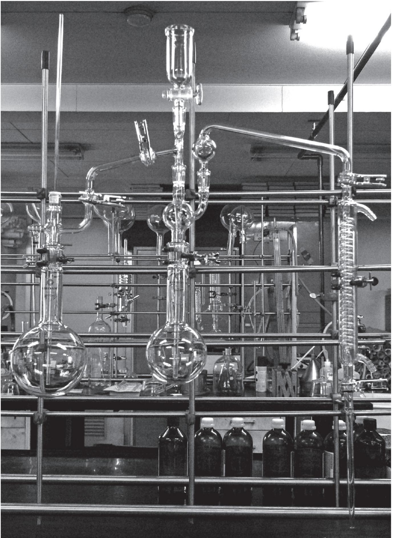
JSN-1 アンモニウムイオン水蒸気蒸留装置(161頁)
