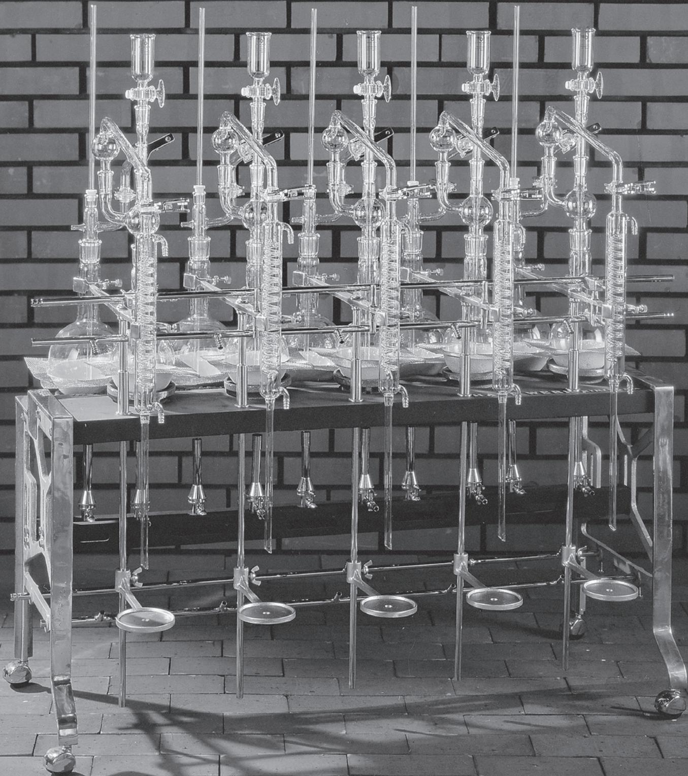
アンモニウムイオン水蒸気蒸留装置5連ガス式(都市ガス、プロパン)
