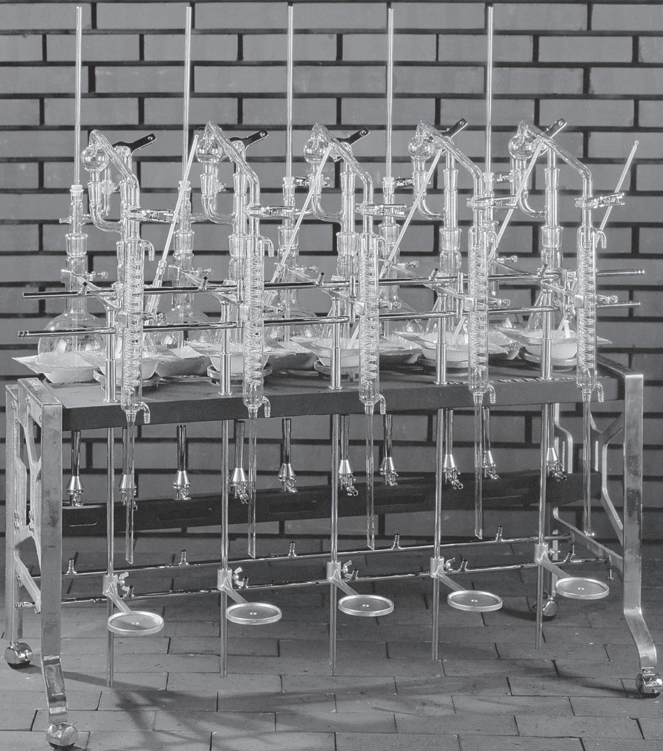
ふっ素イオン水蒸気蒸留装置(その1) 5連ガス式
