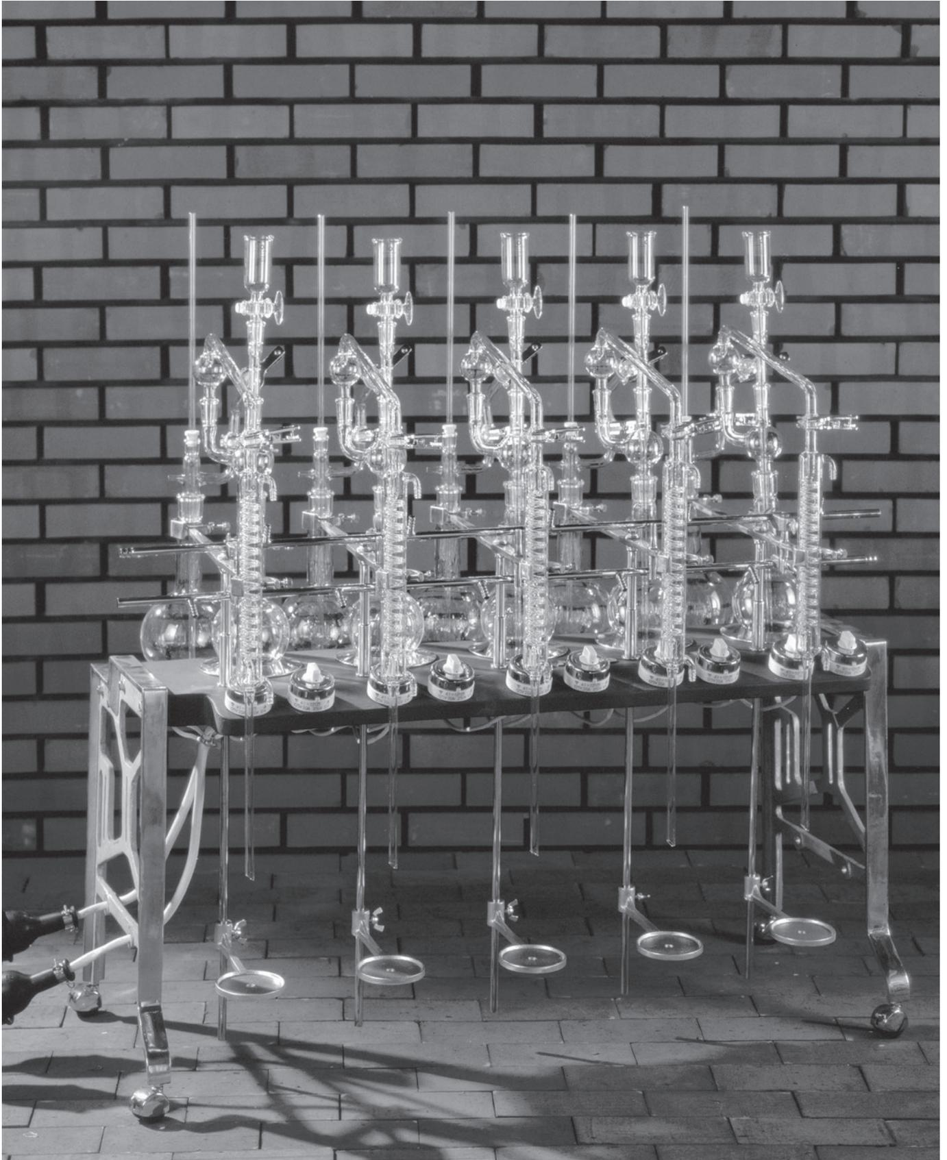
写真はJSN-7アンモニウムイオン水蒸気蒸留装置5連式です(164頁)
