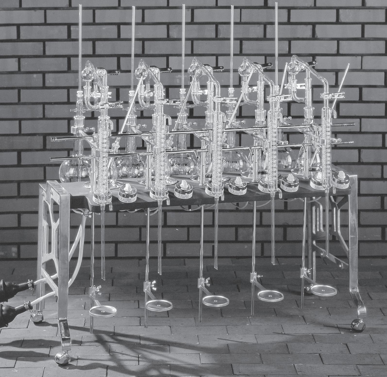
ふっ素イオン水蒸気蒸留装置(その1) 5連電熱式
