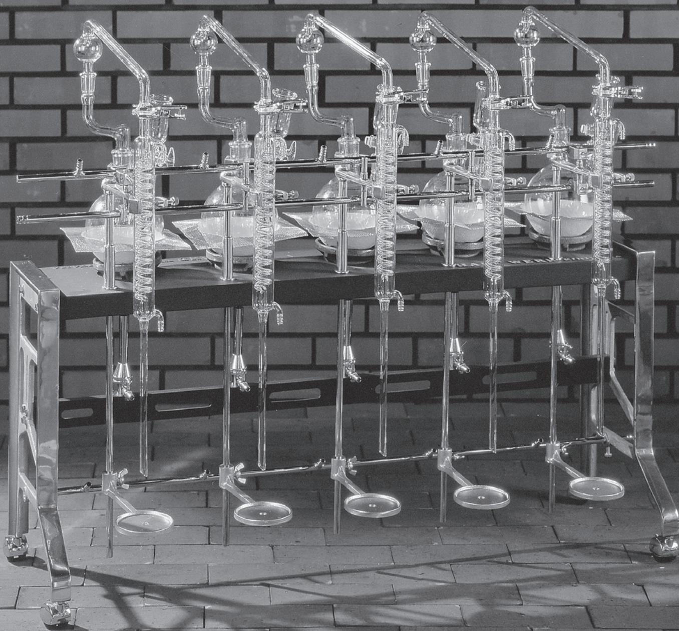
下水法チッソ蒸留装置5連ガス式(都市ガス、プロパン)
